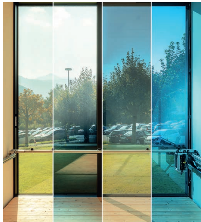
Der HSLU-Lichtmesscontainers zeigt vier Einstellungen von elektrochromen Gläsern: ungetönt, stufenloser Verlauf von oben hell bis unten getönt, stufenloser Verlauf von oben getönt bis unten ungetönt, getönt (Fotomontage).
