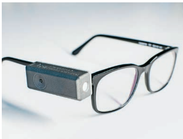
Das Licht-Dosimeter zeichnet die Menge an Licht und dessen Zusammensetzung über die Zeit auf.
