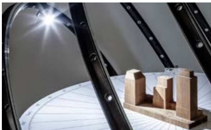
Abb.: Heliodon von Licht@hslu für die Ausbildung am Institut für Gebäudetechnik | Energie (IGE). Foto: Reto Häfliger
