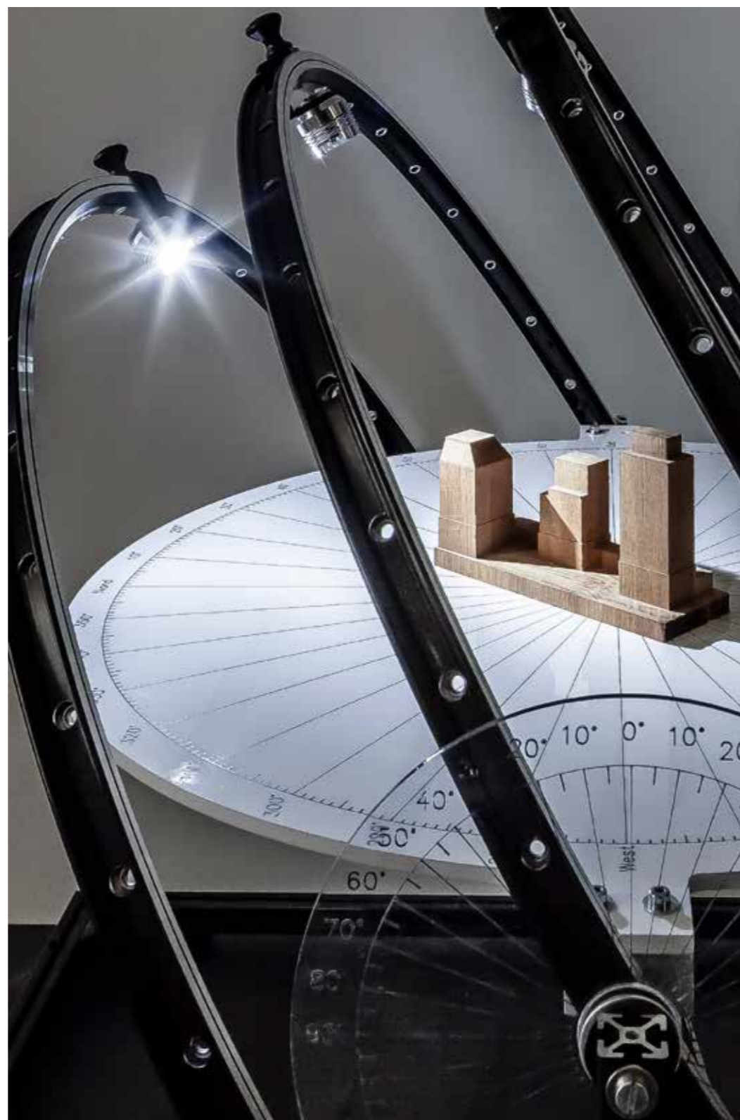
Heliodon von Licht@hslu für die Ausbildung am Institut für Gebäudetechnik | Energie (IGE).
