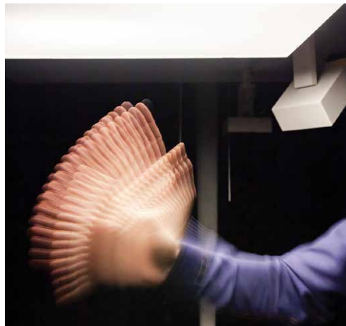
Abbildung 61: Stroboskopischer Effekt bei SVM über 1 [Quelle: Licht@hslu]
