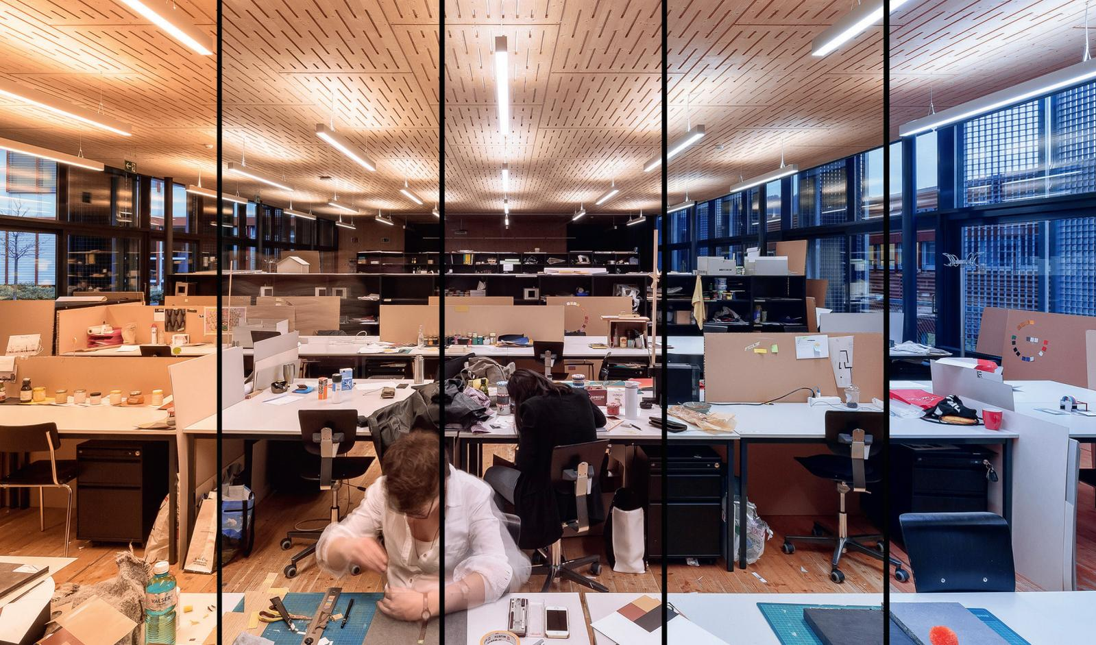
Abb.: Das Innenarchitektur-Atelier der Hochschule Luzern ist mit einer Tunable White-Testanlage (mit Farbtemperaturbereich von 2700 - 6500 Kelvin) ausgestattet. Diese wird genutzt, um Lichtszenarien und -verläufe vor Ort zu testen und mittels Befragung der Studierenden Rückmeldungen einzuholen. Projektpartner: MOOS licht ag und Tridonic Schweiz. Foto: Reto Häfliger
