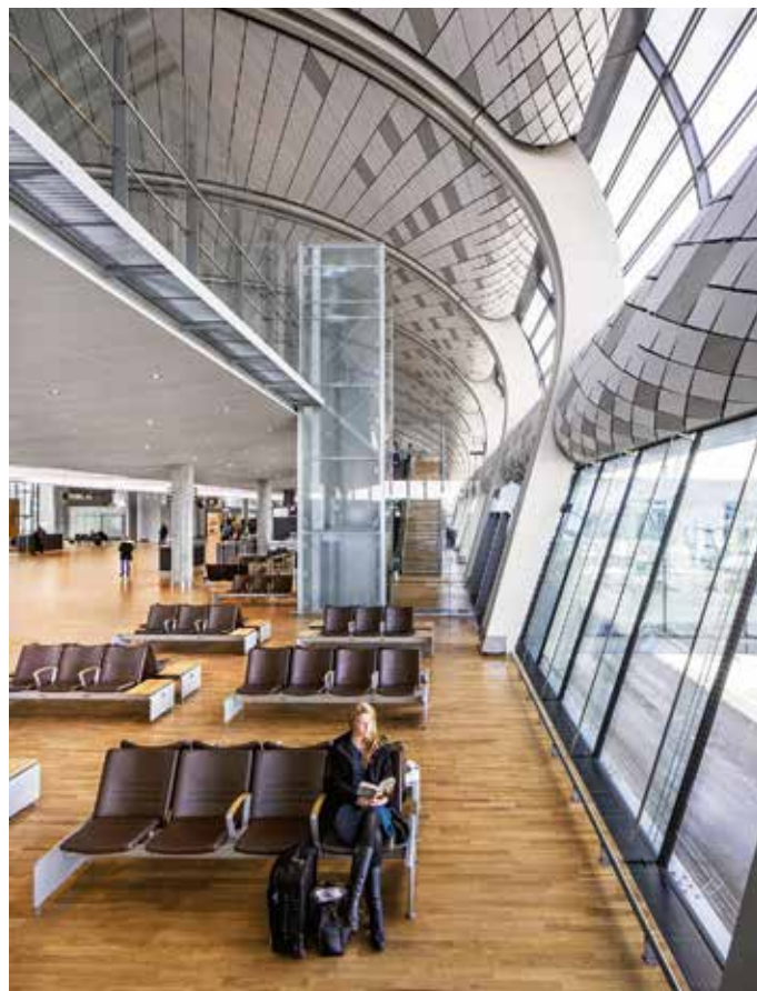
Abb.: Am Flughafen Oslo sorgt Tunable-White dafür, dass die Beleuchtung auf die Qualitäten des außen herrschenden Tageslichts angepasst werden kann. Ein Tageslichtmesskopf misst kontinuierlich das einfallende natürliche Licht und regelt die Beleuchtung so, dass in jedem Raum nur so viel Kunstlicht wie nötig beigesteuert wird. Um eine optimale Kombination aus Kunst- und Tageslicht zu realisieren, wird auch die Lichtfarbe des natürlichen Lichts berücksichtigt und auf die künstliche Beleuchtung im Terminal übertragen.
