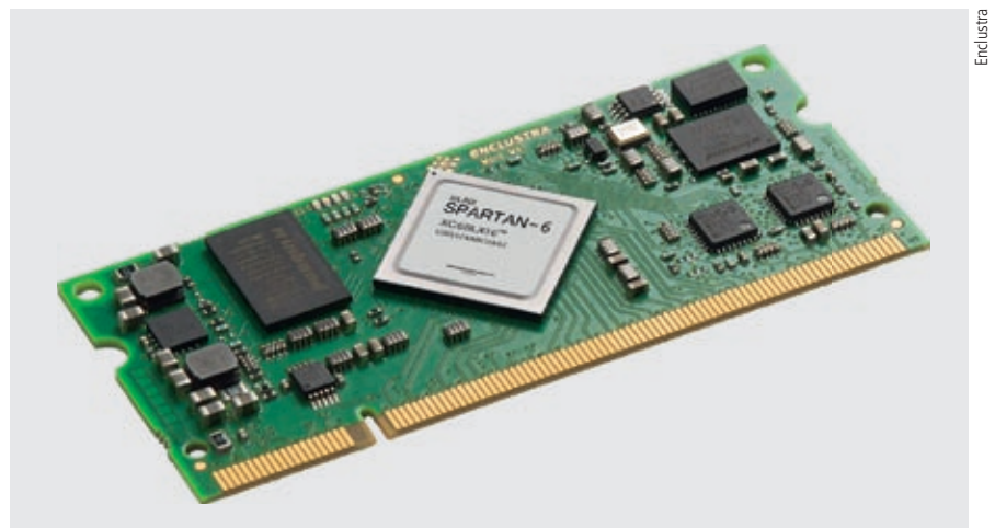
Bild 3 Kostengünstiger Spartan-6-FPGA für Demonstrator.
