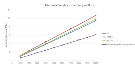
Bild 10: Maximale Vergleichsspannung im Klotz beim Glasversatz
