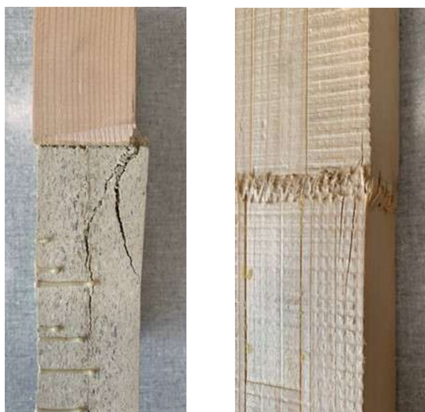
Abb.4: Bruchbild Fi/Purenit Abb.5: Bruchbild Fi/Fi
