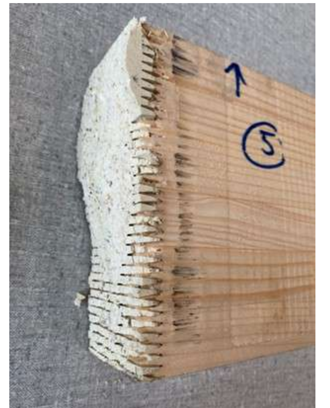
Abb.7: Bruchbild Biegeversuch Fi/Purenit
