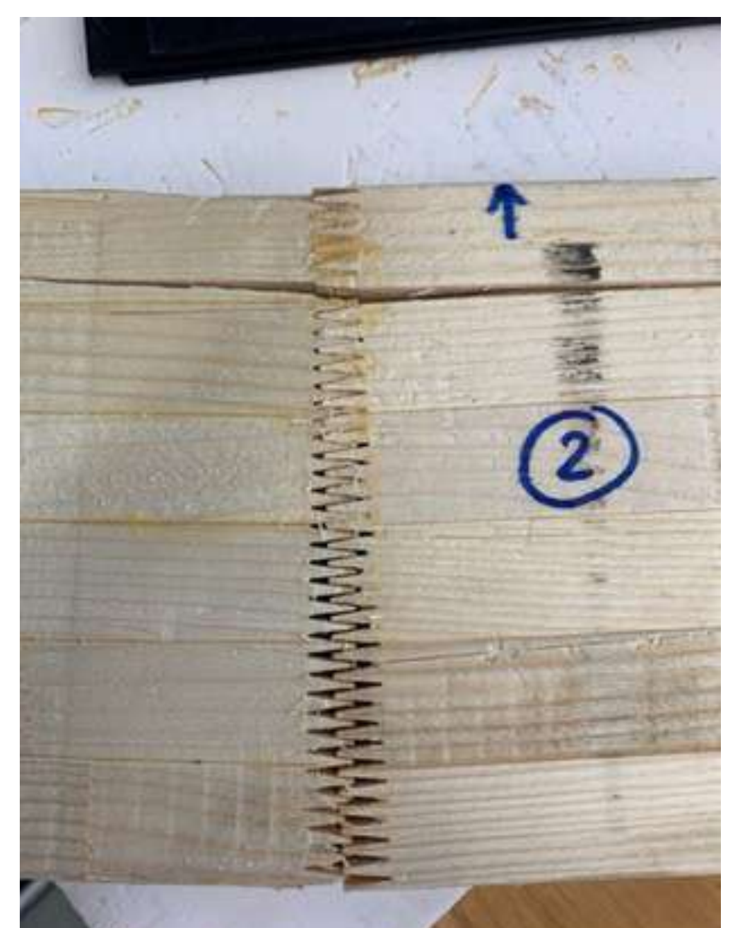
Abb.8: Bruchbild Biegeversuch Fi/Fi
