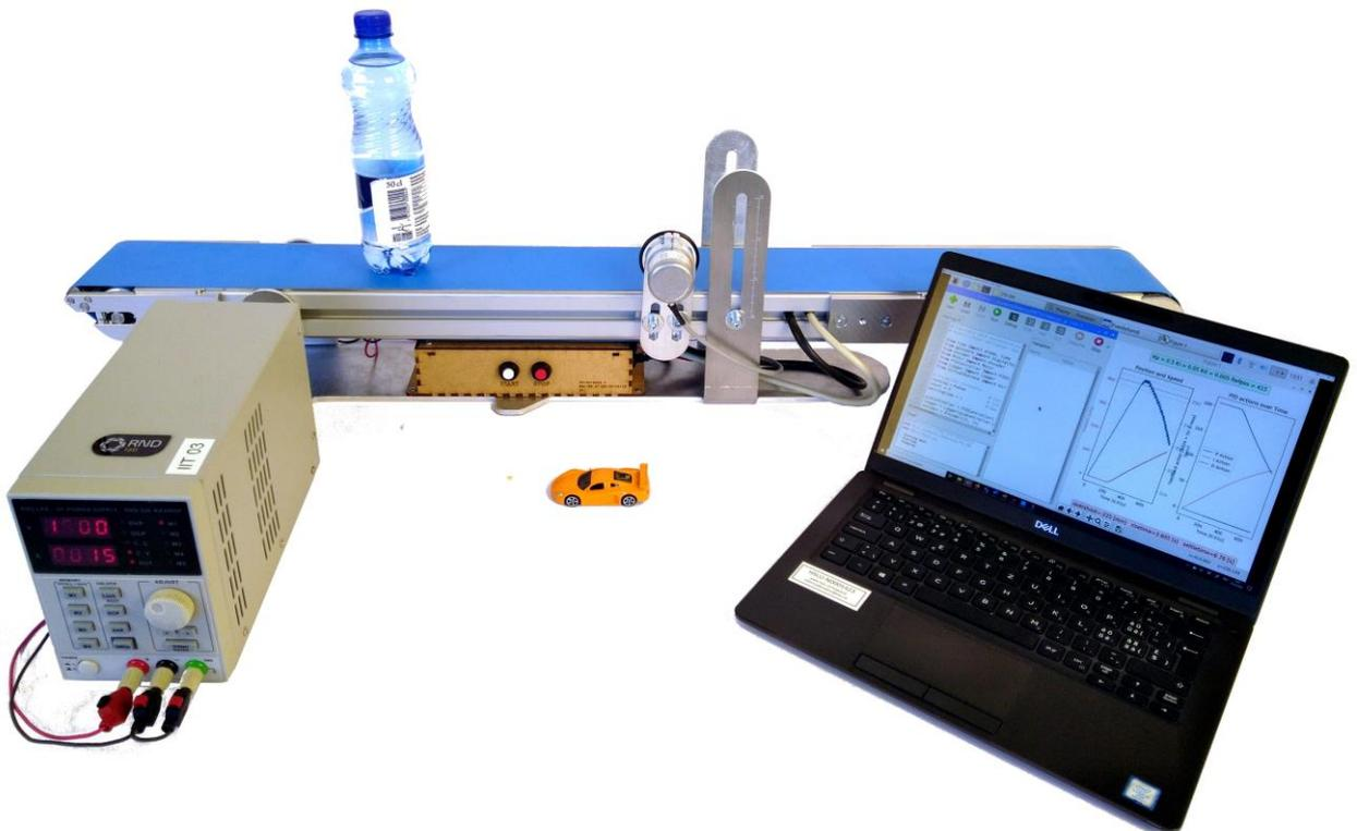
*Abbildung 14: Aufbau der Förderbandübung vor Ort. Anmerkung: Die Kamera für den Remote- und Hybrid-Unterricht steht hinter dem Blickpunkt und ist deshalb nicht zu sehen.*
