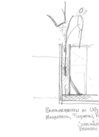
Betonarbeiten im Untergeschoss.
