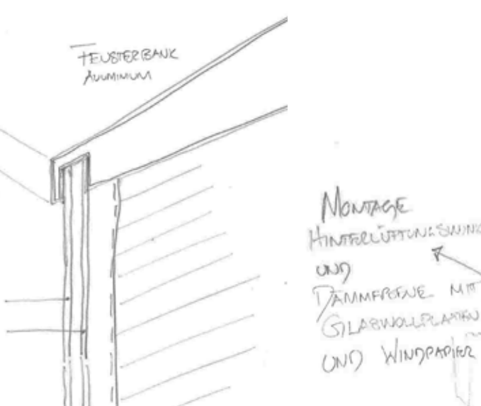
Montagewinkel der Glasbrüstung. Dämmebene mit Glasplatten und Windpapier.
